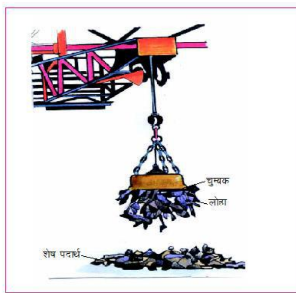
चित्र 4.4 विद्युत चुम्बक द्वारा लोहे की वस्तुओं का पृथक्करण
